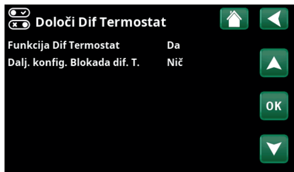
Meni: »Instalater/Določí/Dif. termostata«.
