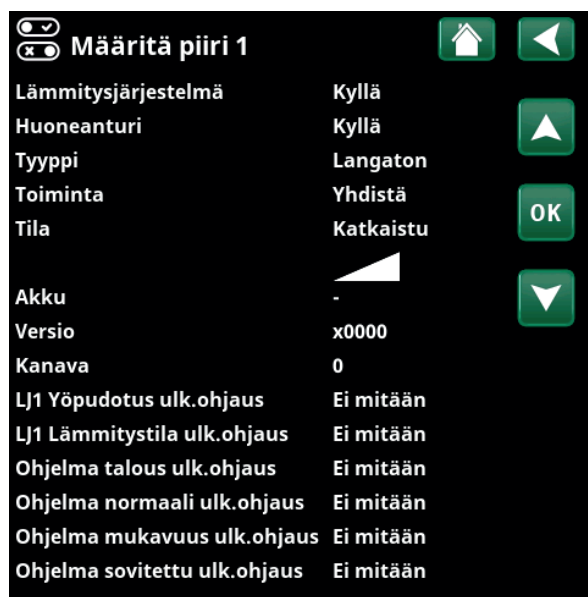
Valikko "Edistyneempi/Määrittele/Lämmitysjärjestelmä/LJ1". Langaton huoneanturi on valittu.
