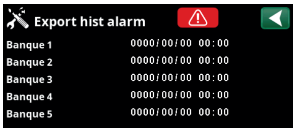
Menu : «Installateur/Service/Export hist alarm»
