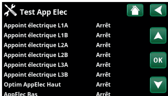
Menu : «Installateur/Service/Test Relais/Appoints électriques ».
