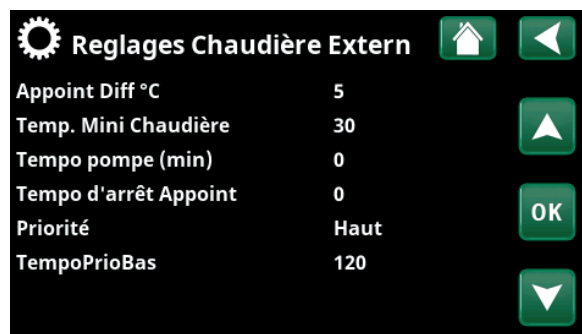
Menu : «Installateur/Réglages/Chaudière externe».
