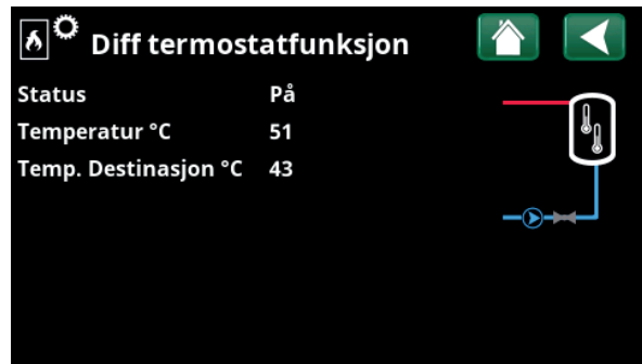
Meny «Driftsinfo/Diff termostatfunksjon».
