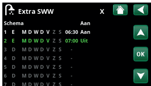
De functie "Extra SWW" is ingesteld om op wekdagen actief te zijn tussen 06:30 en 07:30. Klik op het SWW-pictogram om hieronder een preview te zien.
