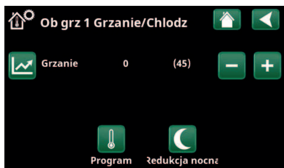
Menu „Instalator/Definiuj/Obieg grzewczy/Obieg grzewczy 1”. Obieg grzewczy nie ma czujnika pokojowego, wartość zadana jest pokazana w nawiasach (temperatura przepływu pierwotnego to 45^{\circ}\text{C} ). Po lewej stronie wartości zadanej znajduje się temperatura zewnętrzna ( 0^{\circ}\text{C} ) przy bieżącej temperaturze obiegu pierwotnego.
