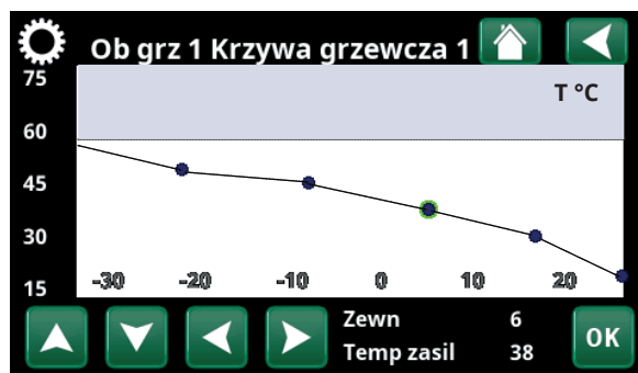
Menü „Instalator\Ustawienia\Obieg grzewczy\Obieg grzewczy 1/ Krzywa grzewcza/Optymalne ustawienie”.
