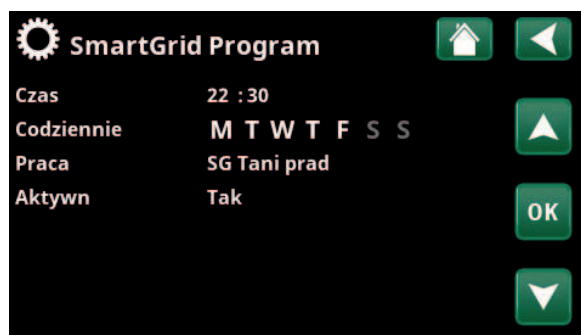
Działanie funkcji SmartGrid „SmartGrid Tani prąd” zaplanowano na dni powszednie w godzinach 22:30-06:00. Przejdź do menu, wybierając pozycję „Tyg. program SmartGrid” w menu „Instalator\Ustawienia”.
