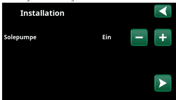
7. Geben Sie mit den Tasten + und - an, ob die Solepumpe Ein, 10d oder Auto ist. Bestätigen Sie die Auswahl mit dem Pfeil nach rechts. Weitere Informationen zu Einstellungen finden Sie im Kapitel „Fachmann/Einstellungen/Wärmepumpe“.
