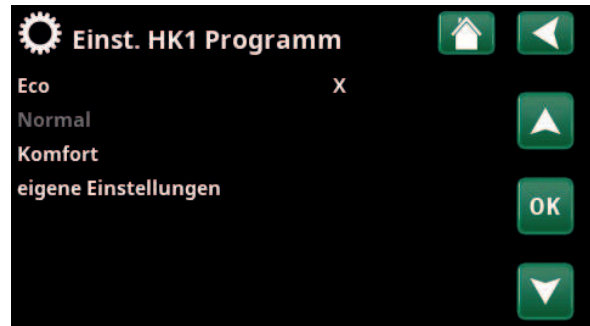
Menü „Fachmann/Einstellungen/Heizkreis/Heizkreis 1/Programm“.
